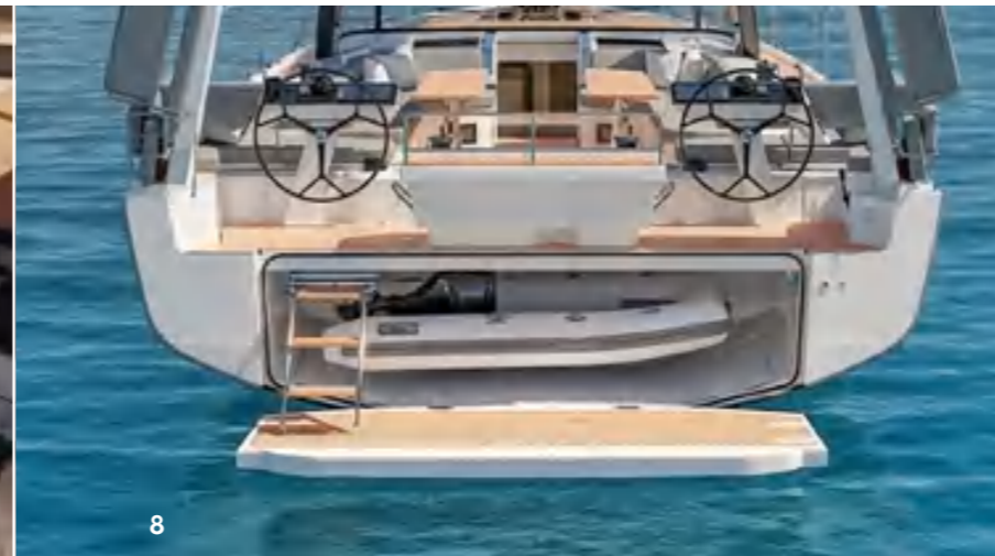
1 Zwei klappbare Steuermannssitze 2 Sonnenpolster-Paket 3 Cockpittisch mit Teakplatte, elektrisch zu Liegefläche absenkbar 4 Gashebel am Instrumententräger 5 Zwei GFK-Stuerräder, Y-Speichen (schwarz oder weiß) 6 Zweites Vorstag mit Rollanlage 7 Zwei elektrische LEWMAR 65 EST EVO Schotwinschen 8 Automatisch ausklappbare Badeplattform mit Badetreppe und Fernbedienung 9 Zwei zusätzliche elektrisch betriebene Schiebeluken beiderseits des Niedergangs 10 Wetbar mit Grill, Spüle und Kühlschrank
