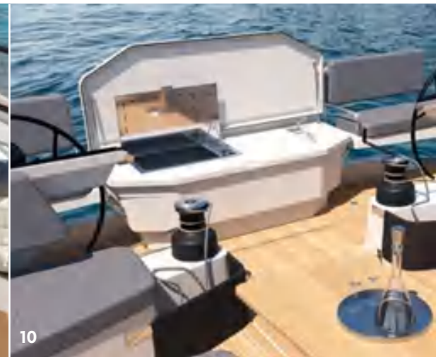
1 Zwei klappbare Steuermannssitze 2 Sonnenpolster-Paket 3 Cockpittisch mit Teakplatte, elektrisch zu Liegefläche absenkbar 4 Gashebel am Instrumententräger 5 Zwei GFK-Stuerräder, Y-Speichen (schwarz oder weiß) 6 Zweites Vorstag mit Rollanlage 7 Zwei elektrische LEWMAR 65 EST EVO Schotwinschen 8 Automatisch ausklappbare Badeplattform mit Badetreppe und Fernbedienung 9 Zwei zusätzliche elektrisch betriebene Schiebeluken beiderseits des Niedergangs 10 Wetbar mit Grill, Spüle und Kühlschrank
